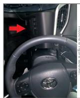
Conector de junção original do veículo localizado acima da caixa de fusíveis.
