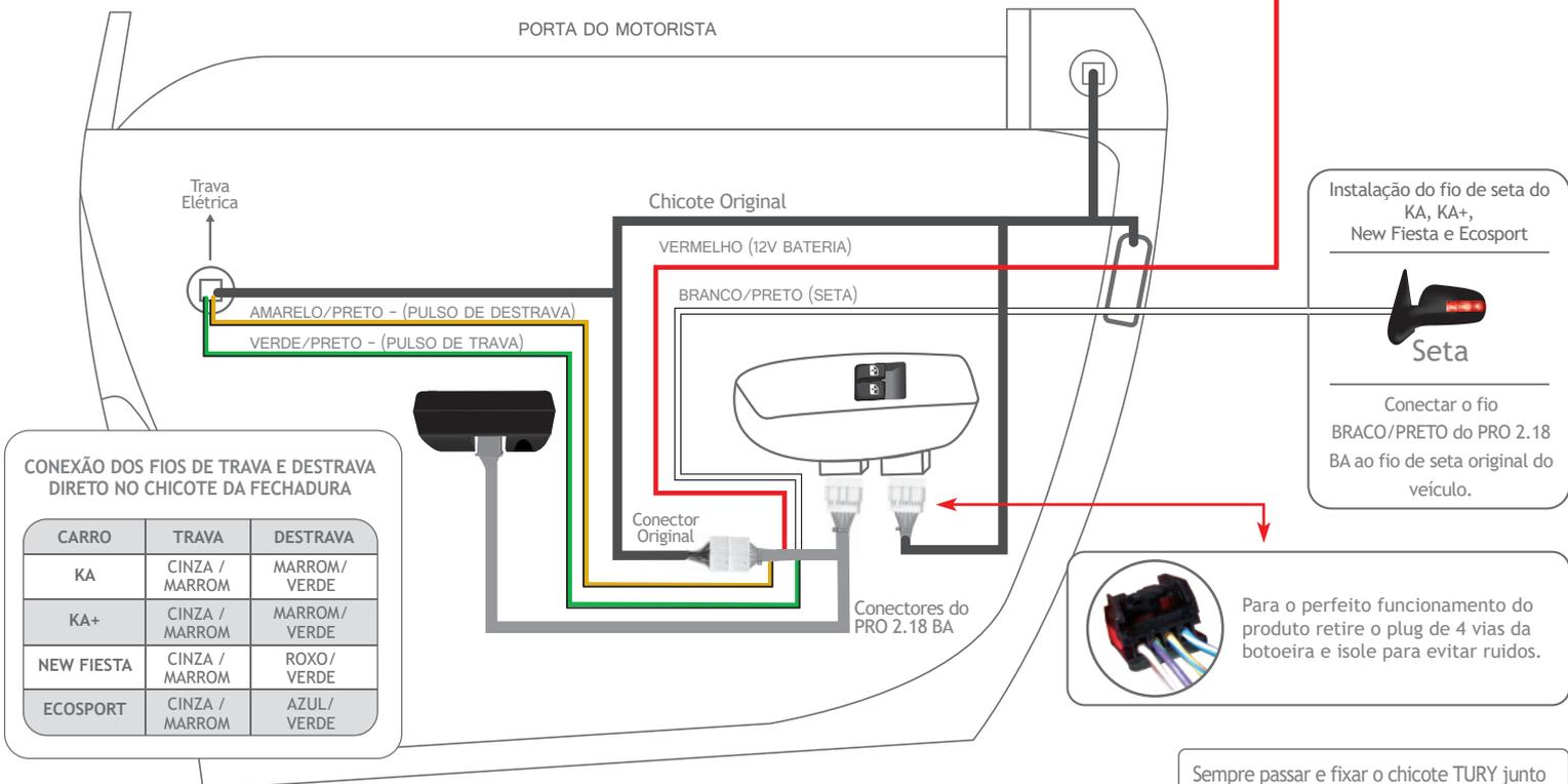
**CONEXÃO DOS FIOS DE TRAVA E DESTRAVA DIRETO NO CHICOTE DA FECHADURA**
