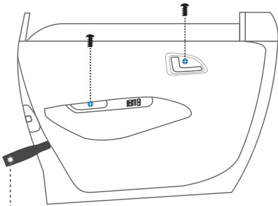
Retire os parafusos localizados na maçaneta da porta e apoio de braço, utilizando uma espátula fina, retire o forro da porta para iniciar a instalação.
