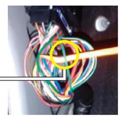
Conectar o fio BRANCO/PRETO do PRO ao fio de SETA original do veículo que esta localizado na coluna inferior esquerda lado do motorista.
