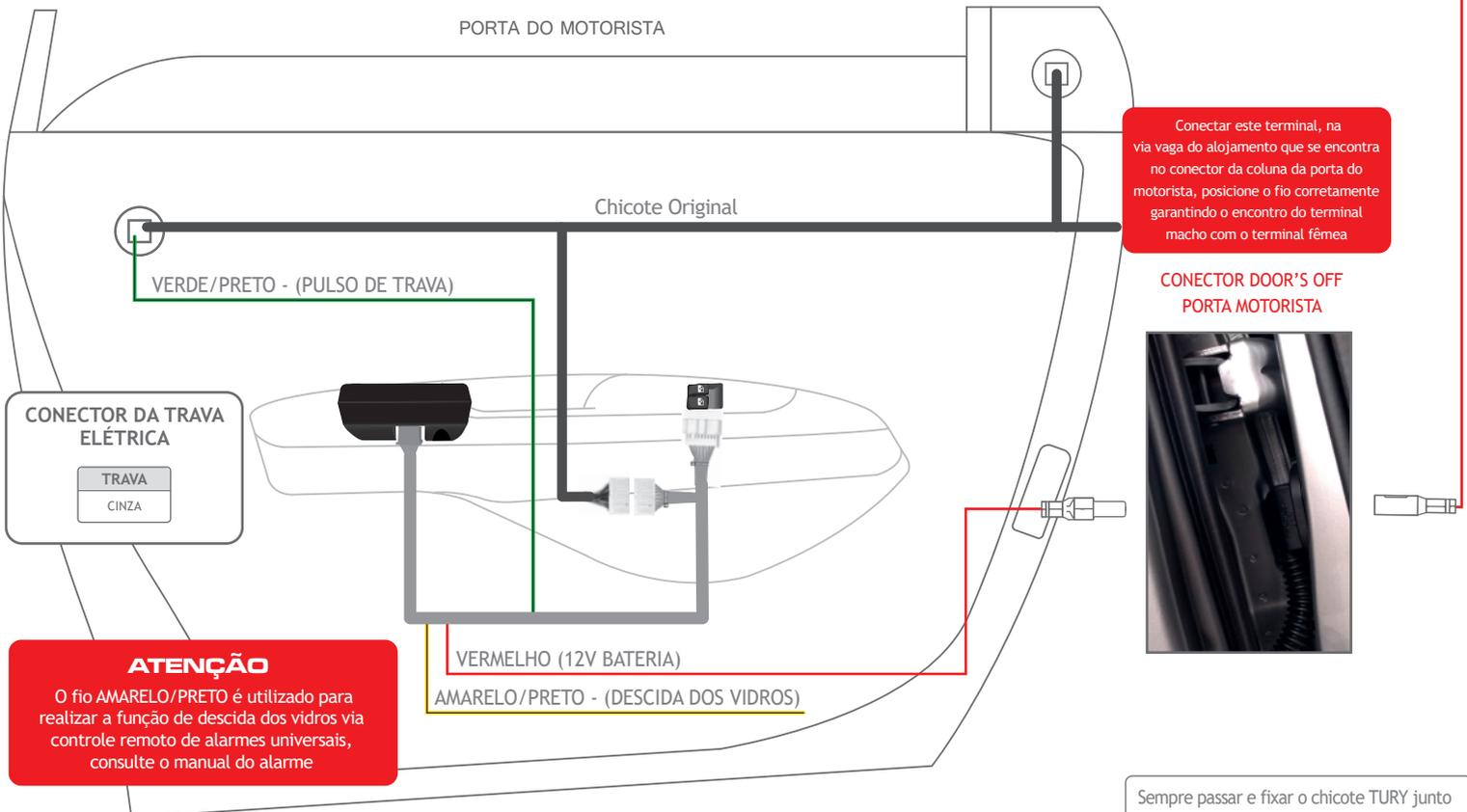
As cores dos fios originais e suas funções e localizações podem variar. Com um multímetro sempre verifique antes de instalar nossos produtos, para evitar possíveis problemas. A TURVY não se responsabiliza por danos causados no sistema elétrico do veículo por falhas de instalação.
