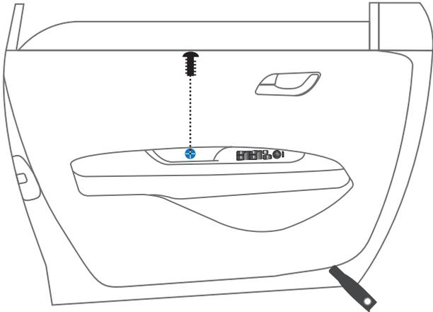
Com uma espátula fina, retire a tampa do parafuso. Em seguida retire o parafuso para retirar o forro da porta e iniciar a instalação.
